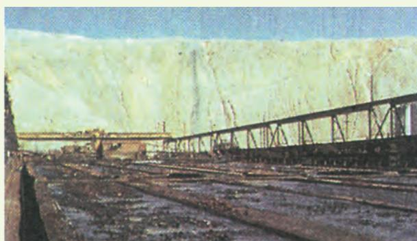
Εικόνα 10.8 Έκπλυση μεταλλευμάτων χαμηλής περιεκτικότητας σε Cu με τη χρήση του βακτηρίου *Thiobacillus ferrooxidans*. Από την κορυφή του σωρού διοχετεύεται νερό με  $H_2SO_4$  που ξεπλένει το μετάλλευμα. Στο τέλος της διαδρομής το διάλυμα είναι πλούσιο σε Cu.
